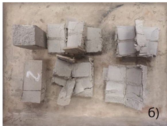
Рис.5. Характер разрушения образцов при изгибе (а) и сжатии (б)
