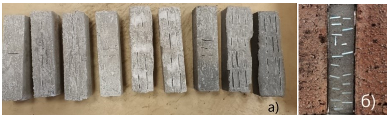
Рис. 3. Общий вид образцов: а) образцы для испытаний; б) презентационный образец для демонстрации светопропускания
