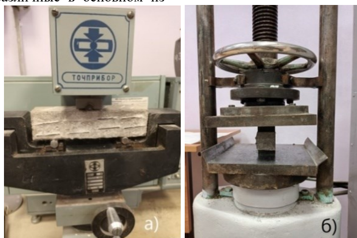
Рис. 1. Испытание образцов на изгиб (а) и сжатие (б)
