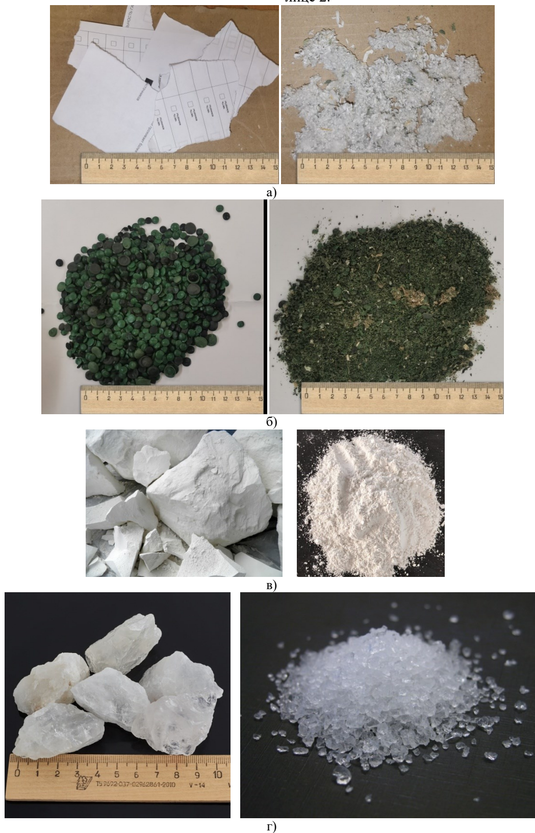
Рис. 3. Результаты исходного и измельченного материала: а) отходы макулатуры; б) отходы пластиковых труб; в) мел; г) кремнезем
